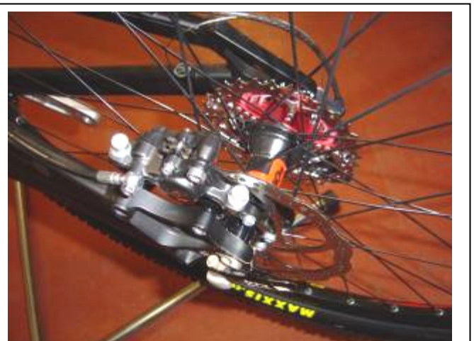
Etrier de frein Formula ORO : On aperçoit les deux vis de réglage latéral.
