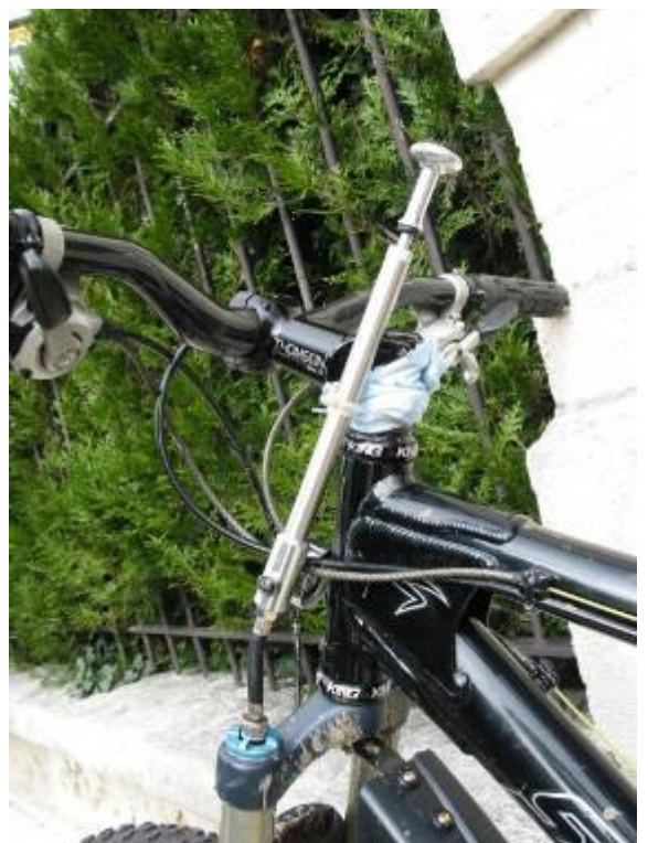
La pompe est fixée à la potence par un collier rilsan et la peinture protégée par un tissu.
