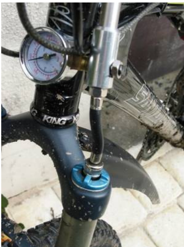
C'est la valve de la pompe qui supplée la valve défectueuse de la fourche.
