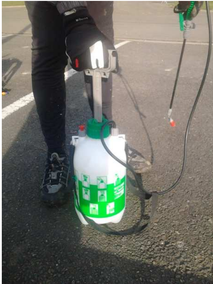
Le pompage pour mettre la pression dans le pulvérisateur.
